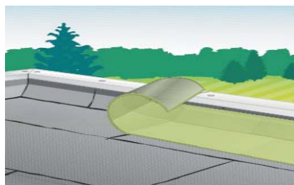
Pilt 2. Vihmaveerenni parandamine
