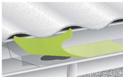
Pilt 1. Vihmaveerenni parandamine
