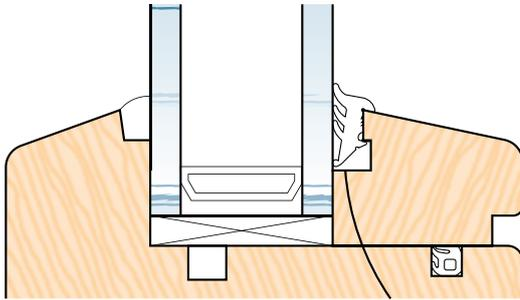
Verglasungsdichtungen dichten als Trockenverglasung den Spalt zwischen Glas und Glasleiste zuverlässig ab und verhindern das Eindringen von Feuchtigkeit in den Glasfalz.
