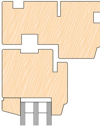
Flügelfalzdichtungen haben als Funktionsdichtungen gegen Luftdurchlässigkeit und für Schlagregendichtheit den entscheidenden Einfluss auf das Dichten und Dämmen. Die zuverlässige Rückstellung wird durch ausgewählte Profilgeometrien in Verbindung mit hochwertigen Werkstoffen sichergestellt. Unsere Flügelfalzdichtungen zeichnen sich durch hohen Toleranzausgleich, komfortables Schließverhalten und Dauerhaftigkeit aus.
