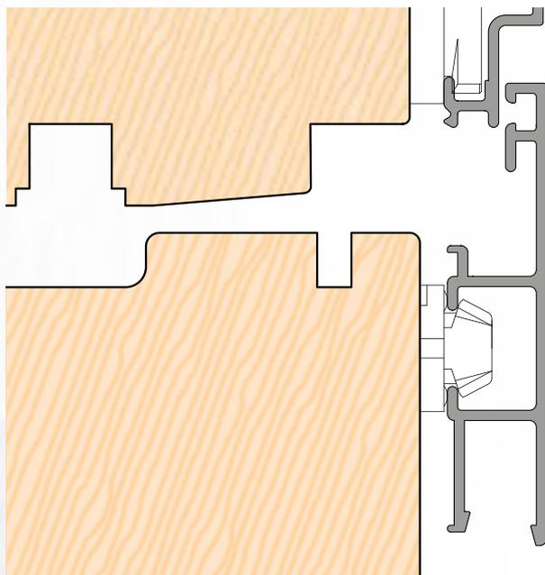
Deventer Anschlagdichtungen – außen – dichten zuverlässig den Spalt zwischen den Aluminiumschalen am Fensterflügel und am Blendrahmen ab.
