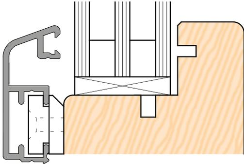
Verglasungsdichtungen – innen – dichten als Trockenverglasung den Spalt zwischen Glas und Glasleiste zuverlässig ab und verhindern das Eindringen von Feuchtigkeit in den Glasfalz. Eine saubere, schnelle und wirtschaftliche Alternative zur Nassverglasung.
