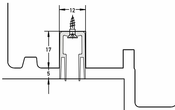
Dichtungen für Schwellenabschluss von Haus- und Balkontüren sind insbesondere für barrierefreies Bauen geeignet. Sie gewährleisten ein zuverlässiges Abdichten gegen Zugluft und Schlagregen. Für den seitlichen Abschluss im Falz empfehlen wir unser Produkt „Phon Stop“. Die Dichtungen zeichnen sich durch einfache Montage mittels Verschrauben in einem Abstand von ca. 20 cm aus.
