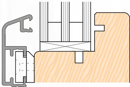
Verglasungsdichtungen – außen – dichten zuverlässig den Spalt zwischen Aluminiumschale, Glas und Glasfalz ab.
