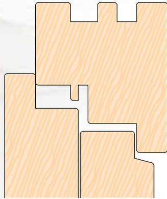
Diese Dichtungen sind für den Blendrahmen von Fenstern und Fenstertüren aus Holz und Holz-Aluminium mit günstigem Drehpunkt.
