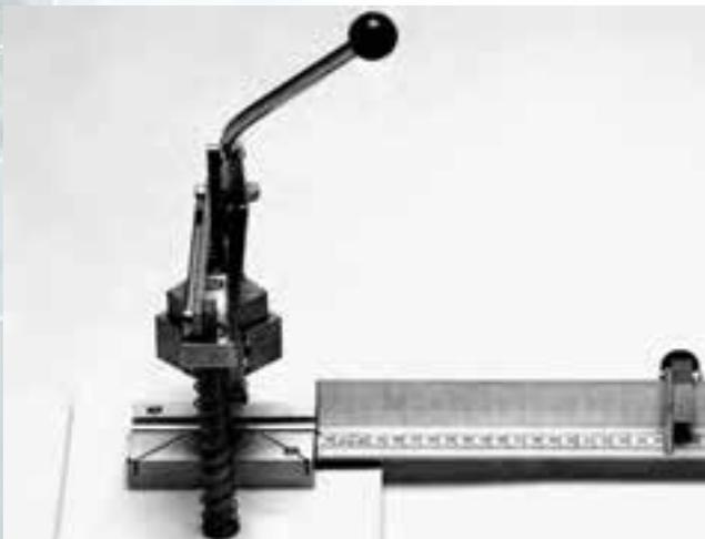
Die Dichtungsstanze DSV 4 wird zum Schneiden von Dichtprofilen auf Länge und Gehrung verwendet. Anschließend werden die Dichtprofile auf dem Dichtungsschweißgerät DSG 4 verschweißt.
