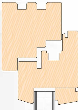
Überschlagdichtungen verbessern den Schallschutz von Fenstern gegen Verkehrslärm und verhindern das Eindringen von warmer, feuchter Raumluft in den Beschlagfalz mit anschließender Kondensatbildung.
