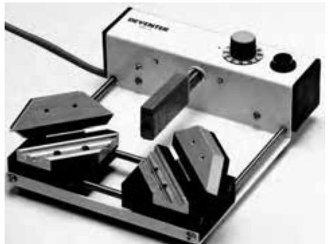
Das Dichtungsschweißgerät DSG 4 wird zum Schweißen von Dichtprofilen auf 90° Ecken verwendet. Vorher werden die Dichtprofile mit der Dichtungsstanze DSV 4 auf Länge und Gehrung geschnitten.
