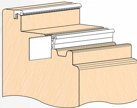
Das Abdichten des Stulpbereichs bei zweiflügligen Fensterkonstruktionen ist eine Herausforderung. Hier kommen spezielle Dichtprofile in Kombination mit unseren Flügelfalzdichtungen zum Einsatz. Besondere Bedeutung hat die Stulpdichtung im Bereich der Überschlagdichtung gegen das Eindringen von warmer, feuchter Raumluft in den Beschlagfalz mit anschließender Kondensatbildung.
