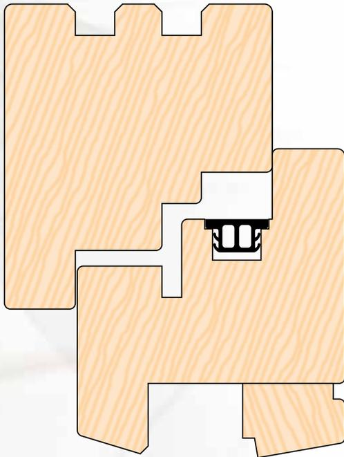
Das Abdichten des Stulpbereichs bei zweiflügligen Fensterkonstruktionen ist eine Herausforderung. Hier kommen spezielle Dichtprofile in Kombination mit unseren Flügelfalzdichtungen zum Einsatz. Besondere Bedeutung hat die Stulpdichtung im Bereich der Überschlagdichtung gegen das Eindringen von warmer, feuchter Raumluft in den Beschlagfalz mit anschließender Kondensatbildung.
