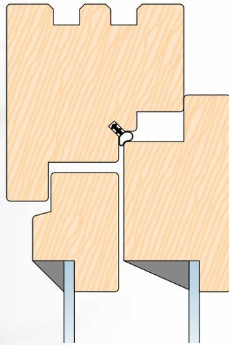
Mit Nutfräsern wird die Nut ohne Ausbau der Fenster gefräst.
