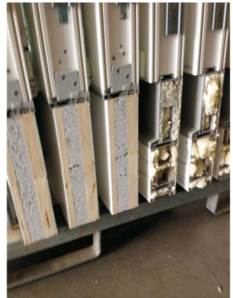
Sokliprofiilid greenteQ lävepaku soojustatud alaprofiiliga PVC / EPS (vasakul pildil) ja tavapärase sokliprofiilid (paremal pildil) võrdlusena.
