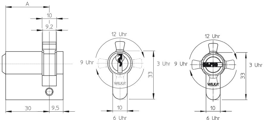
**Halbzylinder mit Freilauffunktion**
