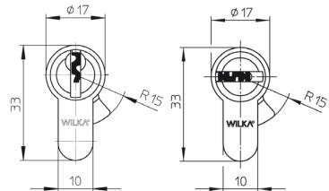
**Symmetrisch****Doppelzylinder mit Notschlüssel****Funktion:**
