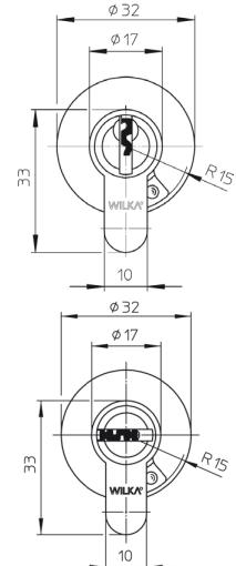
**1484 / 3684****Knaufzylinder asymmetrische / Knob cylinder asymmetric****Knauf - lange Seite /
