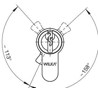
**Schließweg Normalschlüssel/ Cam way standard key****Funktion:****Normalschlüssel:**
